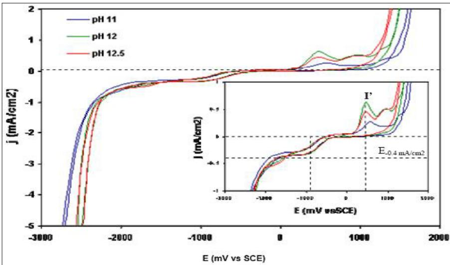
Figura 7. Efecto del pH sobre el comportamiento voltamétrico para un electrodo de carbón vítreo GCE a 25 mV/s en solución cianurada aireada de NaCN = 0.24 M.
