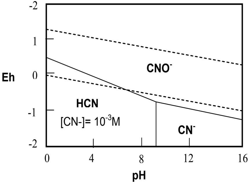
Figura 2. Diagrama potencial vs. pH para el sistema CN-H<sub>2</sub>O a 25°C.
