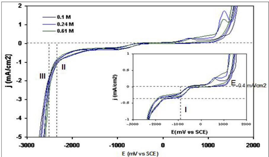
Figura 4. Efecto de la concentración de cianuro sobre el comportamiento voltamétrico para un electrodo de carbón vítreo GCE a 25 mV/s a pH =11.
