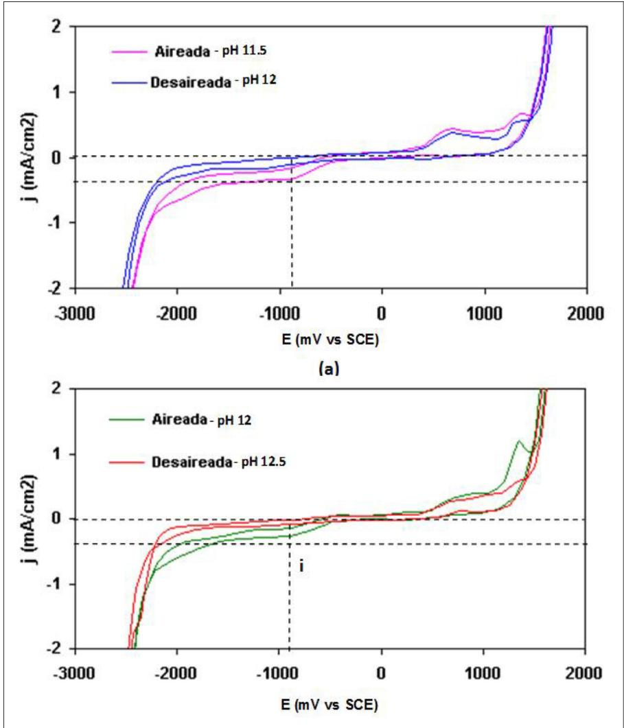
**Figura 8.** Efecto del grado de aireación sobre el comportamiento voltamétrico para un electrodo de carbón vítreo GCE a 25 mV/s (a) NaCN = 0.24 M, (b) NaCN = 0.61 M.
