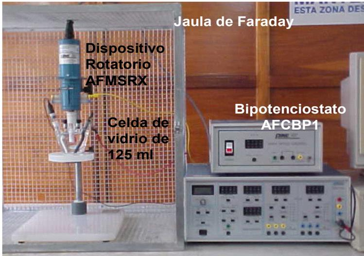
Figura 3. Equipos para realización de ensayos electroquímicos.
