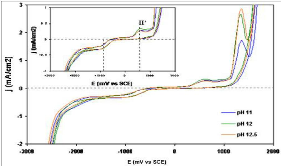
Figura 6. Efecto del pH sobre el comportamiento voltamétrico para un electrodo de carbón vítreo GCE a 25 mV/s en solución cianurada aireada de NaCN = 0.1 M.
