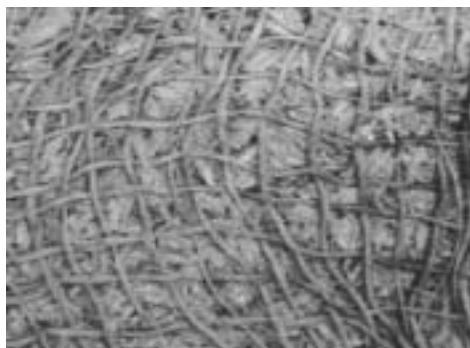
Figura 3. Estructura externa del aglomerado número 3, donde se destaca la cascarilla de arroz y el refuerzo de fique; las fases más claras son partículas de polvo de almidón no hidrolizado.
