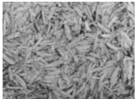
Figura 2. Detalle del aglomerado 2. La estructura mostrada está conformada por cascarilla de arroz sin refuerzo; las fases oscuras son espacios vacíos.
