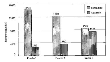
Comportamiento del tiempo encendido y apagado de la resistencia eléctrica para las diferentes pruebas realizadas
