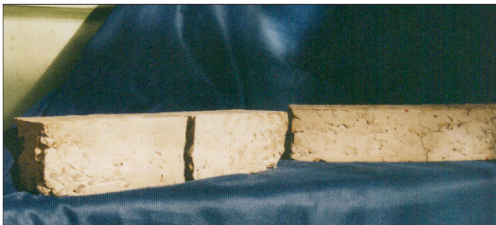
Figura 14. Viga testigo (izquierda) y con fibra, ensayadas a flexión
