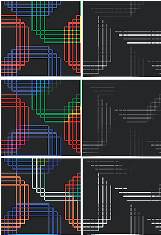
Figura 5. Columna izquierda detección de bordes de la imagen a color, columna derecha detección de bordes con imagen en escala de grises. De arriba a bajo: imagen original, imagen con disminución de brillo, imagen con aumento en contraste y aumento de brillo*
