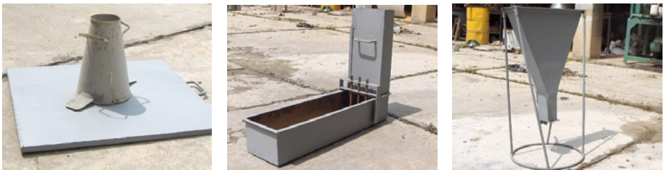
Figura 8. Ensayos en estado fresco realizados, cono de Abrams (izquierda), caja en L (centro) y embudo en V (derecha).
