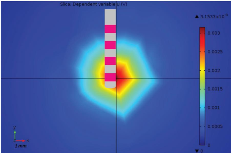
**Figura 4.** Superficie de activación en el plano XY del modelo isotrópico subtalámico para una estimulación constante de corriente de 40  $\mu\text{A}$ . El valor máximo de activación de voltaje alcanza 3.09 mV.
