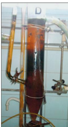
**Figura 6.** Formación de la torta en el decantador secundario proceso FA
