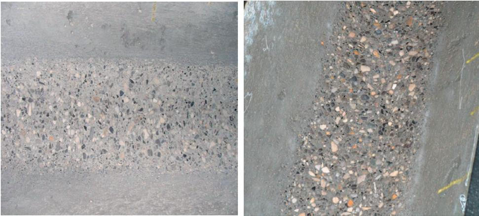
**Figura 5.** Superficies expuestas al material abrasivo luego de 100 000 y 200 000 ciclos, para el ensayo 1 (ver descripción tabla 2)
