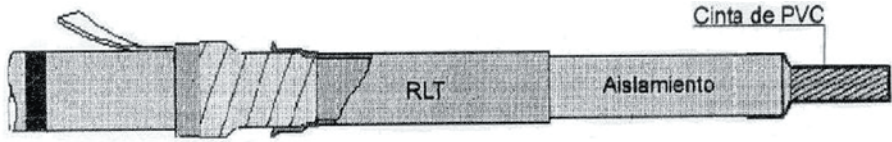
Figura 4. Montaje del repartidor lineal de tensión (RLT) y cinta de PVC sobre un terminal del cable
