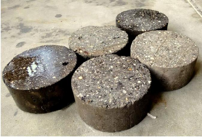
**Figura 3.** Muestras cilíndricas cortadas con sierra diamantada.
