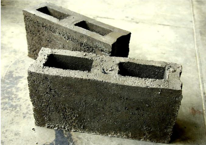
**Figura 6.** Bloque de concreto aligerado para sobrecimiento.
