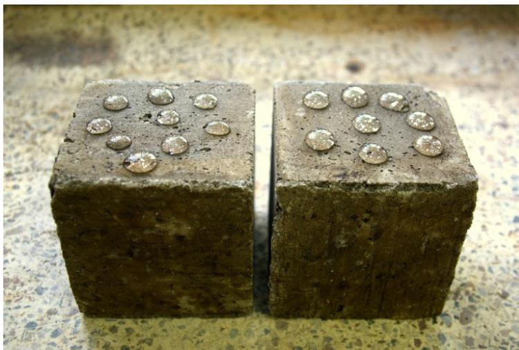
**Figura 1.** Bloque de concreto con emulsión asfáltica.
